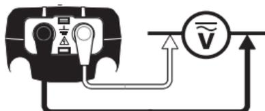
**⚠ Use terminales de prueba con clasificación CAT III o superiores.**
